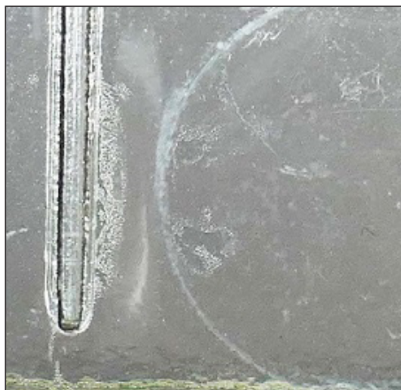
Fig. 10. Nedbrytningsprodukter från plastens mjukgörare i form av bubbelbildning.
